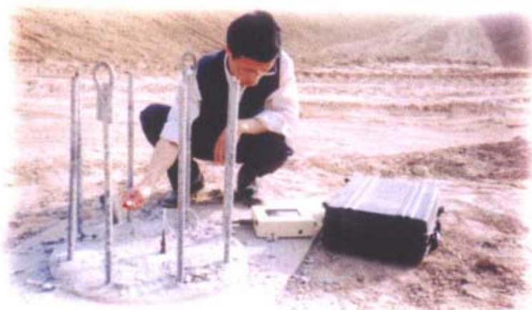
利用美国产测试仪对基桩进行检测
