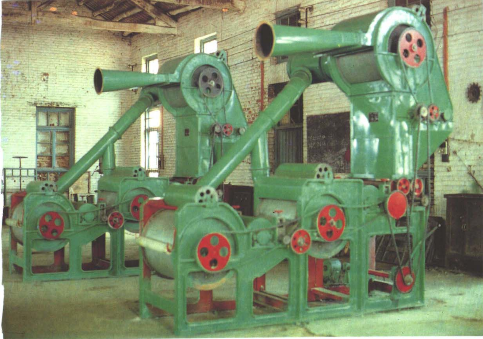
冠縣機械廠 生產的 6 MK— 500 型全自動棉包 鐵絲打扣機，獲 山東省優質產品 獎。
